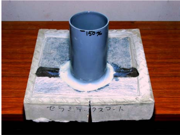
ジョイント部にセラミテックスコート を塗布 ※ポリマーセメントペースト系塗膜防水材料
